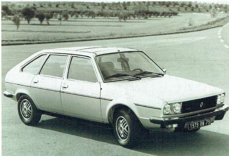
La Renault 30 TX se reconnaît à ses roues à croisillons en alliage léger et au monogramme « injection » apposé sur la calandre.
