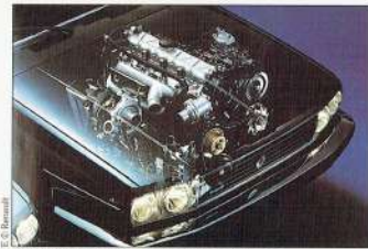
En 1982 apparaît la R30 Diesel, dont la mécanique reçoit un turbo-compresseur donnant ainsi 85 ch.
