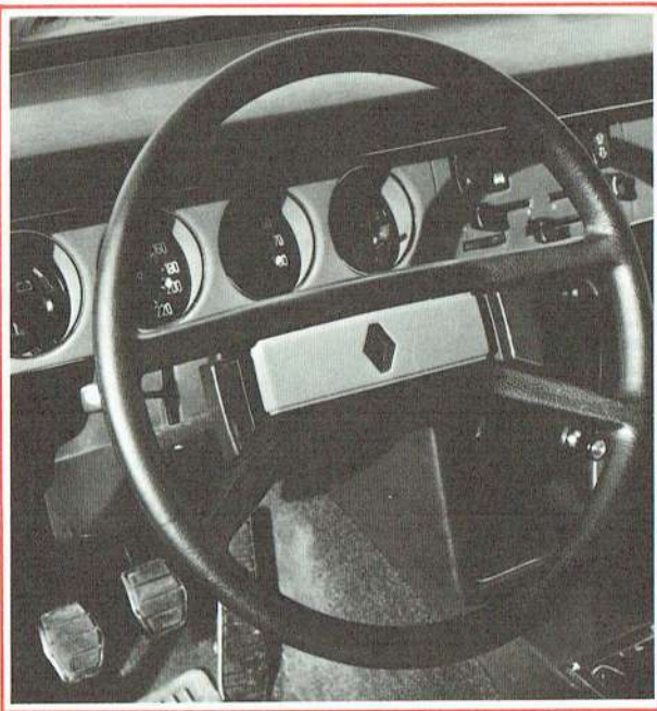
Das Lenkrad ist nicht nur griffig und gepolstert, sondern seine 4 nahe beieinander liegenden Speichen sorgen zusammen mit der dazwischen liegenden Prallplatte dafür, daß auch bei einem Aufschlagen des Kopfes möglichst wenig Verletzungen entstehen.
