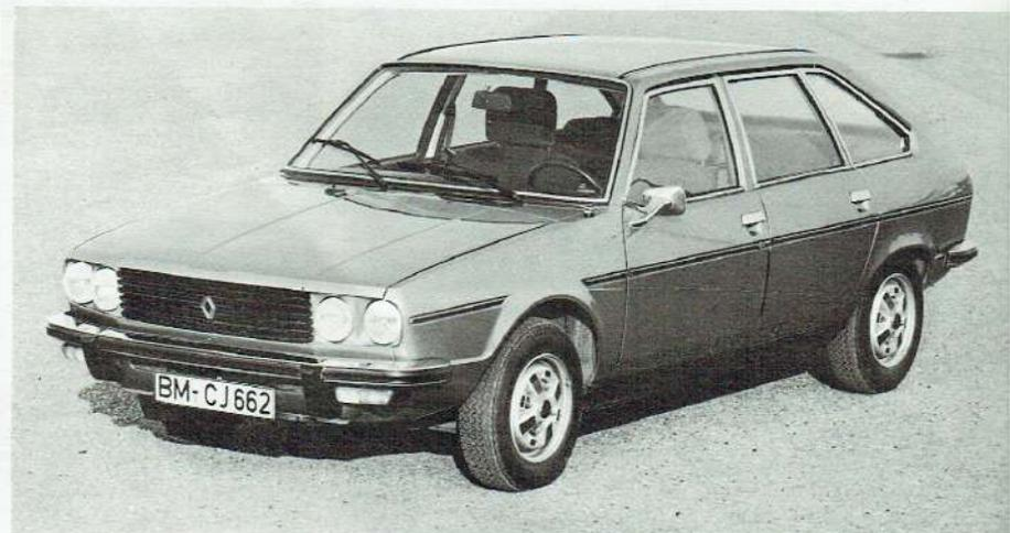
Hoher Komfort und große Sicherheit für die Insassen durch Vorderradantrieb und Schräglenker-Hinterachse
