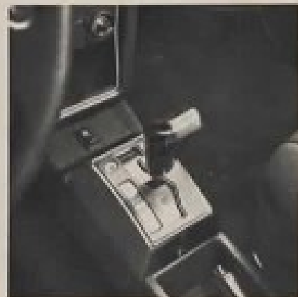
La commande de sélection de la boîte de vitesses automatique est d'une conception originale. Le cheminement du levier interdit toute manœuvre intempestive.
