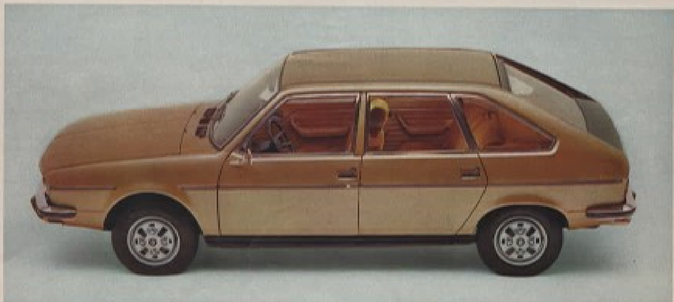
La partie arrière de la Renault 30 TS est transformable, le volume disponible variant de 400 cm 3 à 1 400 cm 3 , selon le déplacement de la banquette arrière.
