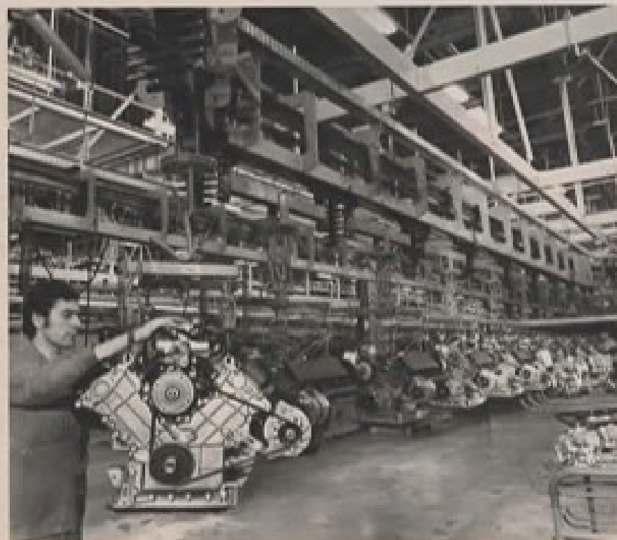
Le moteur V 6 en fin de chaîne de montage, à l'usine de la Française de Mécanique de Douvin.
