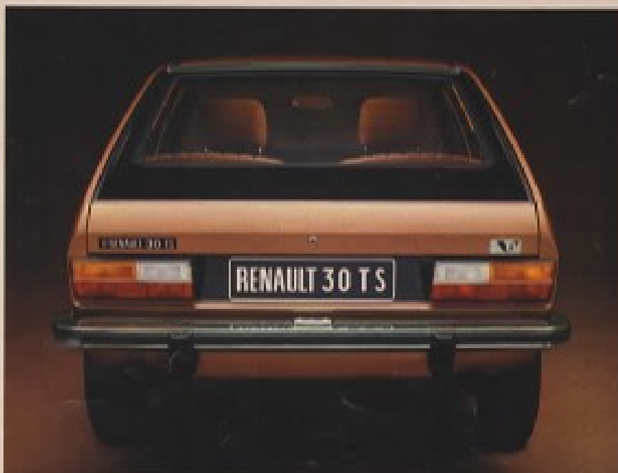
Les pare-chocs comportent de gros butoirs. Le long du pare-choc, un bourrelet de caoutchouc absorbe les petits chocs et évite les griffures.
