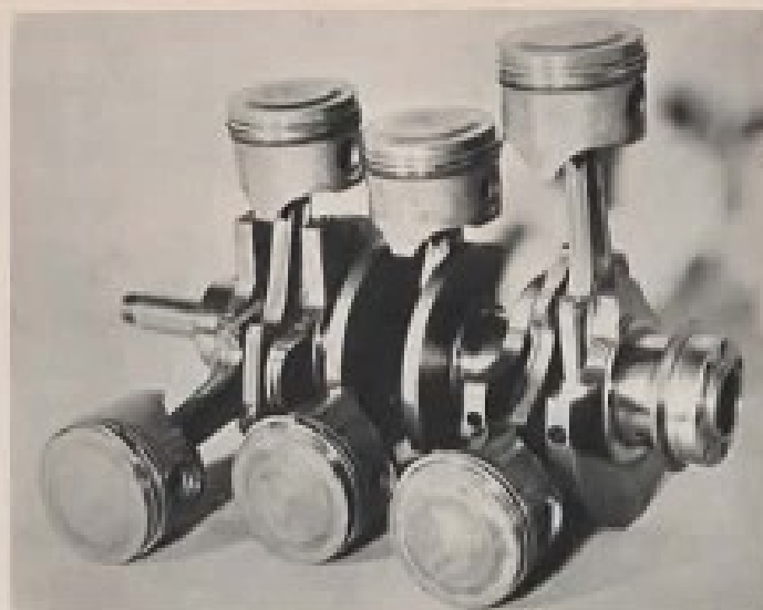
Le vilebrequin comporte trois manetons calés à 120° l'un de l'autre; chacun reçoit un couple de bielles.
