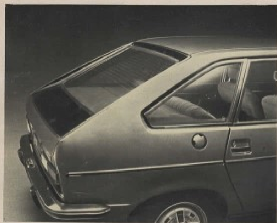
La ceinture de caisse protège la carrosserie des rayures et des chocs latéraux.
