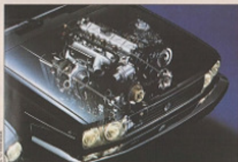
En 1982 apparaît la R30 Diesel, dont la mécanique reçoit un turbocompresseur d'un côté ainsi 85 ch.
