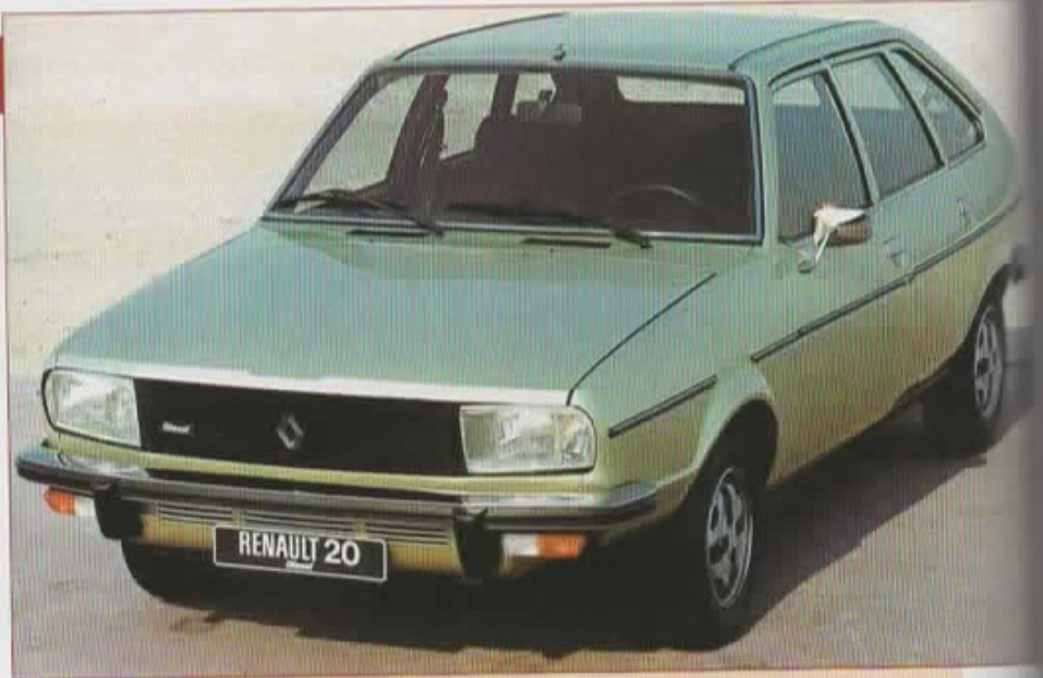
Ci-dessus et ci-contre. Van de l'extérieur, la nouvelle Renault 20 à gazole ne se distingue de ses sœurs à essence que par ses nuances de style avec jante bicolorée et son minuscule monogramme « Diesel » apposé sur la calandre. Construit par la Société Française de Mécanique Douvrin, le nouveau 2 litres diesel adopté par Renault singularise par son arbre à cames en tête et son bloc en alliage d'aluminium. Lors de son lancement en décembre 1979, la Renault 20 coûte 49 700 F en finition TD et 53 800 F en version GTD.
