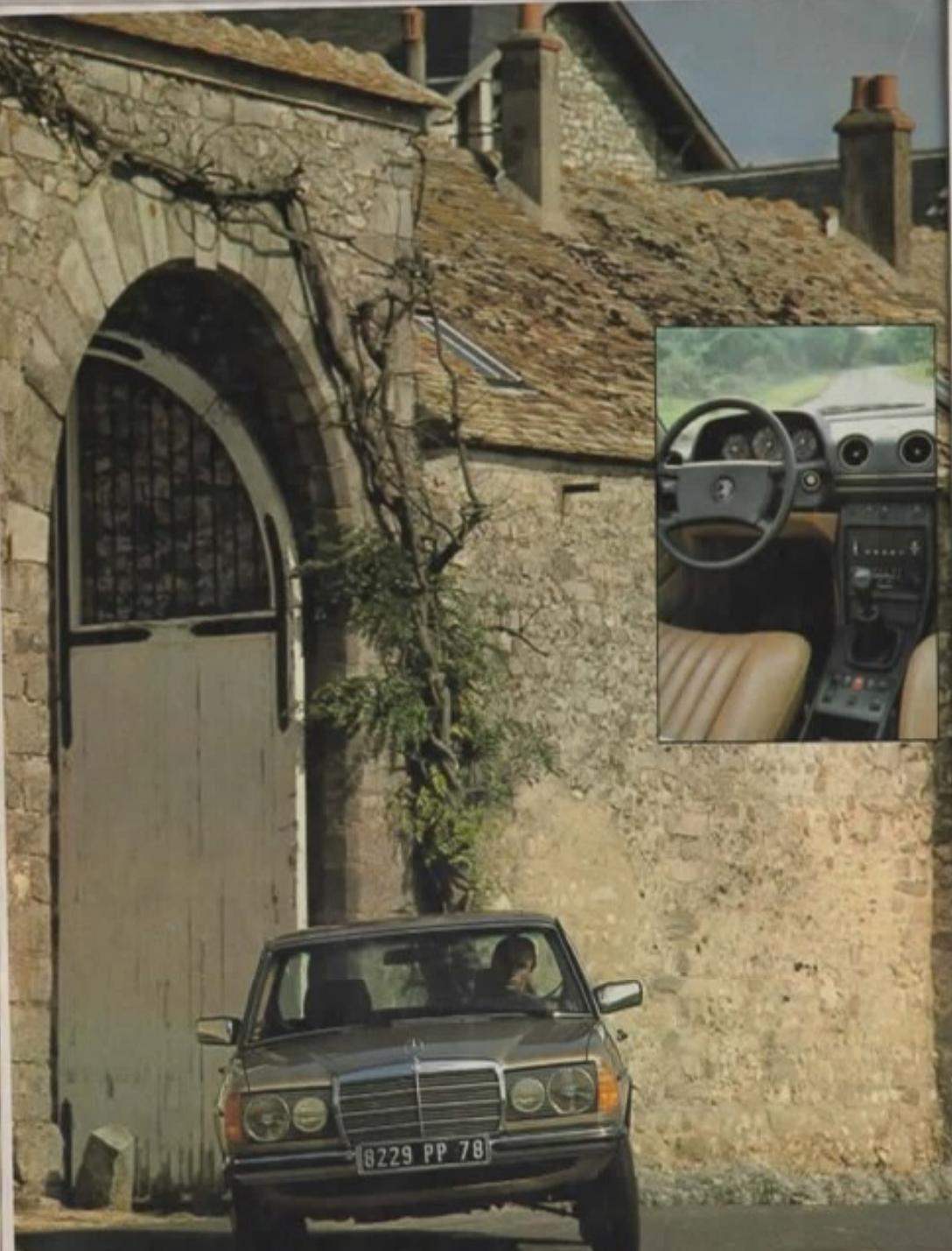
Mercedes-Benz 230 E. 1981. 2299 cm<sup>3</sup>, 10 CV fiscaux, 136 ch DIN à 5 100 tr/min, 4 cylindres en ligne, boîte de vitesses à 5 rapports, direction assistée, freinage ABS, climatisation, etc.
