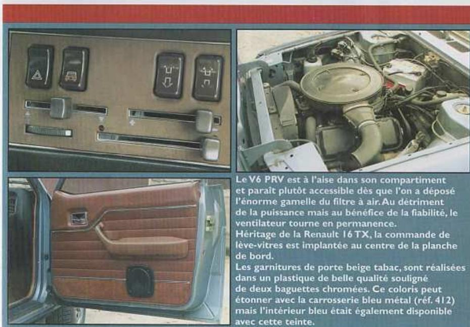
Le V6 PRV est à l'aise dans son compartiment et paraît plutôt accessible dès que l'on a déposé l'énorme gamelle du filtre à air. Au détriment de la puissance mais au bénéfice de la fiabilité, le ventilateur tourne en permanence.
