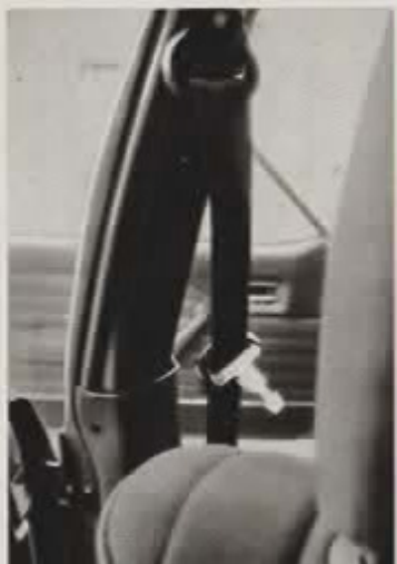
Les ceintures AV à enrouleur sont guidées le long du pilier
