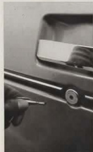
Nouveauté : la clé cylindrique actionnant un barillet à piston
